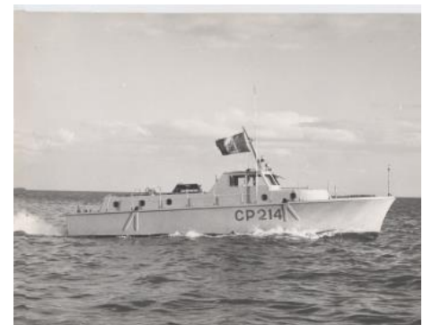
Fig. 56. Motovedetta litoranea CP 214, appartenente alla classe di 24 unità chiamate scherzosamente "Caterina" dagli equipaggi. Lunghe 11,5 metri e dotate di un solo motore, erano concepite per uso foraneo e portuale.
