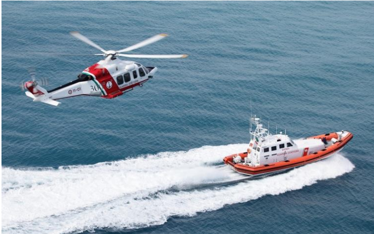
Fig. 83. Una unità “Classe 300” e un velivolo AW139 della Guardia Costiera in attività operativa. Le motovedette di salvataggio “ogni tempo” classe 300, prodotte in 20 esemplari e tuttora in produzione, si sono rivelate particolarmente idonee nei soccorsi a migranti.
